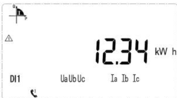
Energía activa directa actual 12,34kWh
